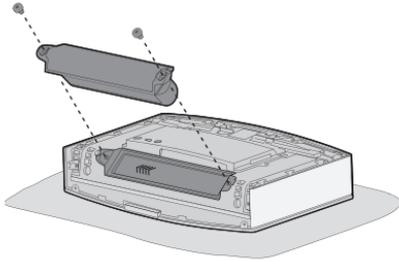
10. Alignez les loquets du couvercle sur les onglets et pressez le couvercle vers le bas.
