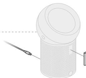
La télécommande se fixe magnétiquement sur l'avant de votre ventilateur purifiant Dyson.
