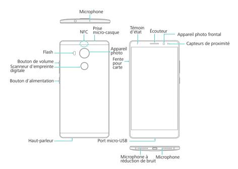
Ne pas couvrir le capteur de proximité, car cela affecterait certaines fonctions du téléphone. Si vous utilisez un protecteur d'écran, ne pas couvrir le capteur. Utiliser un protecteur d'écran qui est conçu pour votre téléphone avec un trou spécialement conçu pour le capteur.
