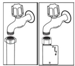
NB: Certains modèles utilisent un système Aquastop. Si votre lavevaisselle est équipé de cette option, il y a du courant avec une tension dangereuse. Ne coupez jamais l'embout Aquastop et veillez à ce qu'il ne soit pas plié ou tordu.
