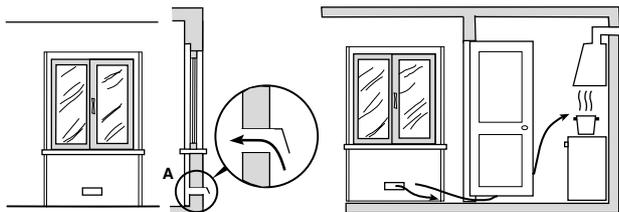
Ouverture de ventilation pour l'air comburant
