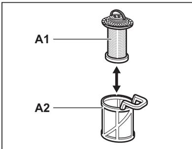
2. Pour démonter le filtre **(A)**, détachez **(A1)** et **(A2)**.
