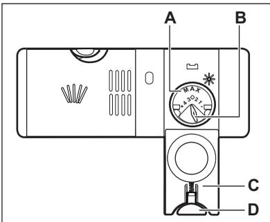
1. Appuyez sur le bouton d'ouverture (D) pour ouvrir le couvercle (C).
