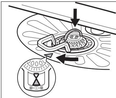
6. Assurez-vous que le filtre **(B)** est correctement positionné, sous les 2 guides **(C)**.
