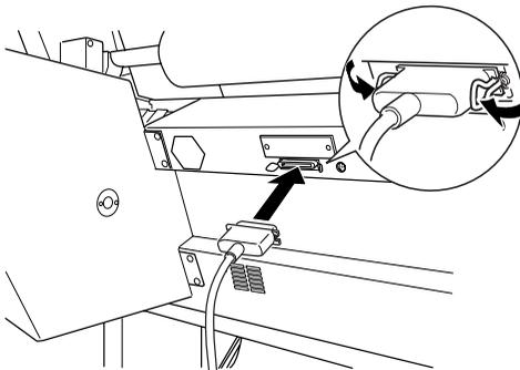
3. Enfichez l'autre extrémité du câble dans le connecteur d'interface parallèle de l'ordinateur. Si cette extrémité est munie d'un fil de masse, connectez ce dernier au connecteur de masse situé à l'arrière de l'ordinateur.
