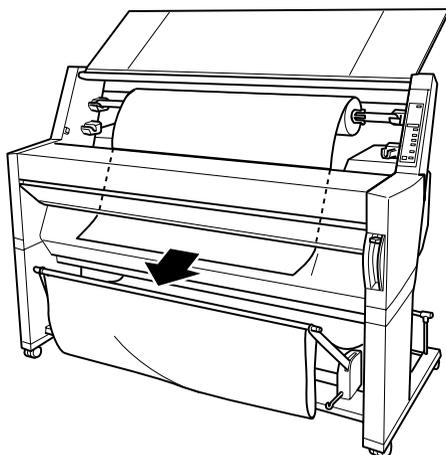
7. Tendez le papier en tournant le rouleau. Assurez-vous que le bord inférieur du papier est rectiligne et correctement aligné avec les rangées de trous poinçonnés.
