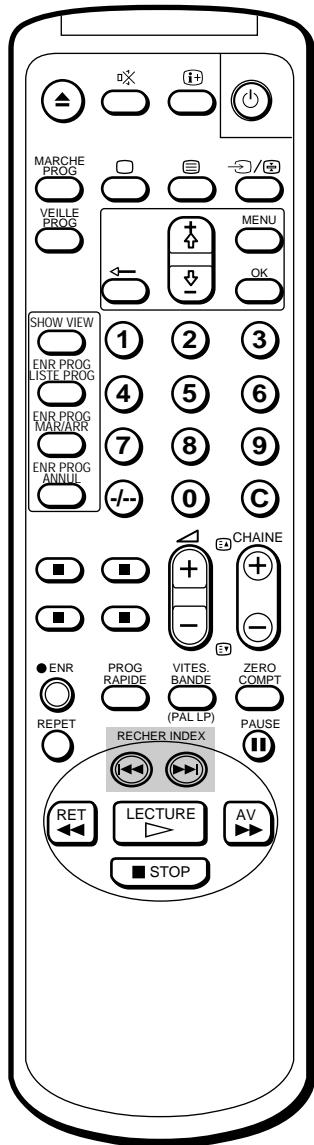
L'apparecchio video TV inserisce nel nastro un segnale di indice nel punto in cui inizia ogni registrazione. Questi segnali possono essere utilizzati in seguito per trovare una registrazione specifica. L'apparecchio video TV è in grado di cercare avanti e indietro in un nastro fino a 99 segnali.
