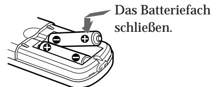
Die beiden R6-Batterien mit der richtigen Polarität einlegen.
