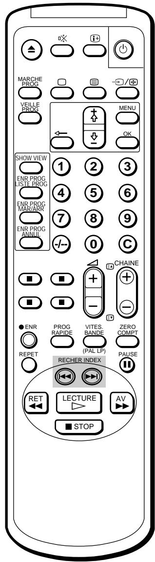
Das Video-TV-Gerät setzt jeweils am Anfang einer neuen Aufnahme als Markierung ein Indexsignal. Anhand dieser Signale können Sie hinterher bestimmte Aufnahmen mühelos wiederfinden. Das Video-TV-Gerät kann auf dem Band 99 Signale vor oder nach der aktuellen Position suchen.
