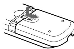
Fernbedienung umdrehen und den Batteriefachdeckel abnehmen.
