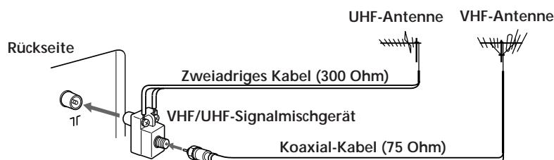
Wenn Sie die Antenne angeschlossen haben, verbinden Sie das Netzkabel mit einer Netzsteckdose.
