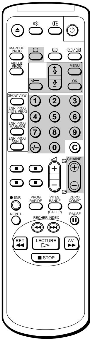
La funzione ShowView semplifica la programmazione delle registrazioni con il timer. Far corrispondere la posizione di programma di ogni canale al canale guida (il numero originariamente assegnato ad ogni stazione televisiva). Per ottenere i numeri del canale guida, consultare la guida televisiva locale che possiede i codici ShowView.
