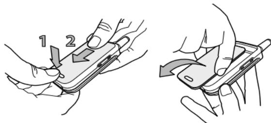
2. Déposez la batterie en appuyant sur les clips intérieurs, l'un après l'autre, puis en tirant la batterie à partir de la gauche.
