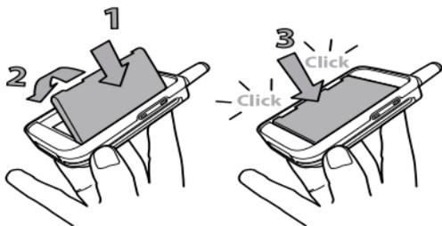
5. Remettez le cache de la batterie en le glissant jusqu'au fond du compartiment, connecteurs métalliques vers l'intérieur.
