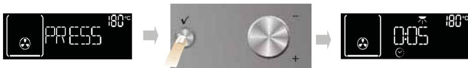
Une fois la durée de cuisson écoulée, l'afficheur montre : « PRESS ✓ TO BROWN » (appuyez ✓ pour dorer). En appuyant sur la touche ✓, le four lance la phase de « Dorage » pendant 5 minutes. Cette fonction ne peut être effectuée que deux fois.
