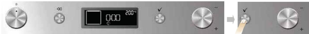
1. Tournez le bouton « Fonctions » sur la fonction choisie: les paramètres de cuisson apparaissent sur l'afficheur.
