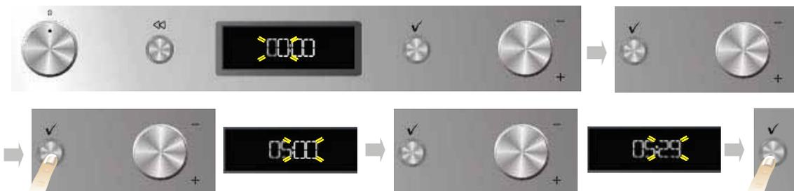
Après avoir branché le four au réseau électrique, il est nécessaire de renseigner l'heure courante. Les deux chiffres relatifs à l'heure clignoteront sur l'afficheur.
