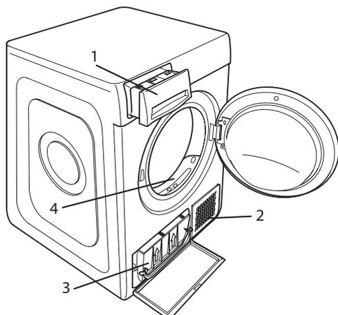
**Les filtres sont des composants fondamentaux du sèche-linge. Leur fonction est de recueillir les peluches qui se forment lors du séchage. Si les filtres sont bouchés, le flux d'air à l'intérieur du sèche-linge est gravement compromis : les temps de séchage s'allongent, on consomme davantage d'énergie et le sèche-linge peut subir des dommages. Si ces opérations ne sont pas effectuées correctement, le sèche-linge peut ne pas démarrer.**
