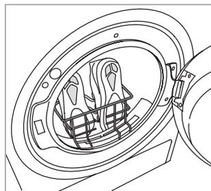
Retirer le filtre porte et positionner le râtelier. Les lacets doivent être enfilés à l'intérieur des chaussures : les pointes dirigées vers le bas et les semelles devant. Ne pas ajouter de linge ou d'autres chaussures dans le panier. Remettre le filtre porte à la fin du séchage.
