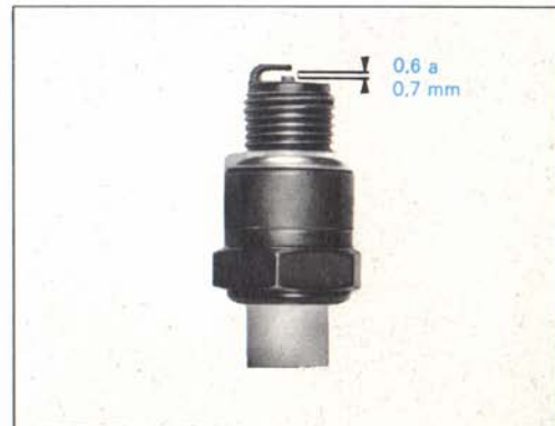
Fig. 42 - Bougies Écartement des électrodes
