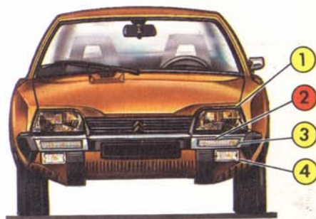
Fig. 53 - Éclairage extérieur et signalisation avant 1 - Projecteurs code/route 3 - Feux de position 2 - Indicateurs direction 4 - Anti-brouillard
