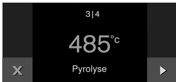
Un signal retentit une fois la pyrolyse terminée. Un message apparaît. Lorsque l'appareil a refroidi, essuyez les cendres restantes dans le compartiment de cuisson à l'aide d'un chiffon humide.
