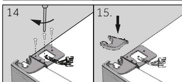
Stellen Sie sicher, dass das Drehgelenk in die Scharnieraufhängung der unteren Tür passt.
