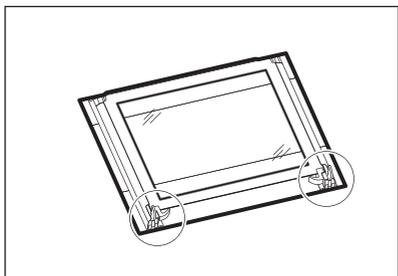
8. Désengagez le système de verrouillage pour retirer les panneaux de verre intérieurs.
