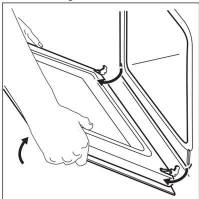
7. Déposez la porte sur une surface stable recouverte d'un tissu doux.
