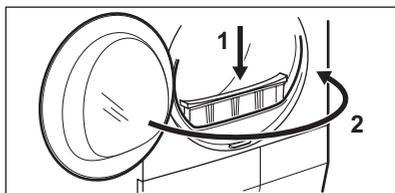
1) Si nécessaire, nettoyez le filtre avec une brosse sous un filet d'eau chaude du robinet et/ou avec un aspirateur.
