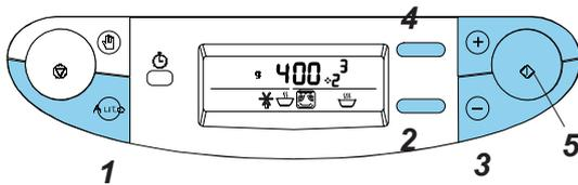
**Les fonctions automatiques de ce four** doivent connaître le poids net des aliments. Le four calcule automatiquement le temps nécessaire à la décongélation ou à la cuisson en fonction du poids.
