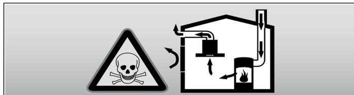
Les foyers à air ambiant (par exemples les chauffages à gaz, à bois, à fioul ou à charbon, les chauffe-eau instantanés, les ballons d'eau chaude) prélèvent l'air de combustion dans la pièce où ils sont installés et rejettent les gaz de fumée à l'air libre par un système spécifique (cheminée par exemple).
