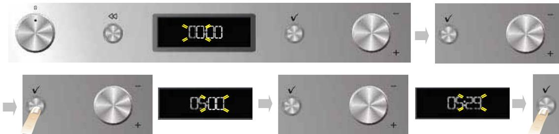
Après le réglage de la langue, il est nécessaire de régler l'heure. Les deux chiffres relatifs à l'heure clignoteront sur l'afficheur.
