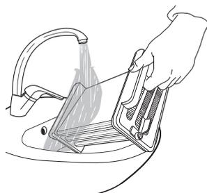
Nettoyez la chambre du filtre du sèche-linge avec un chiffon humide ou minutieusement avec un aspirateur. Réinsérez le filtre inférieur. Faites pivoter les barres de verrouillage vers le haut en position verticale. Fermez le volet inférieur.
