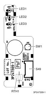
PCB (4): INTELLIGENT EYE Sensor PCB
