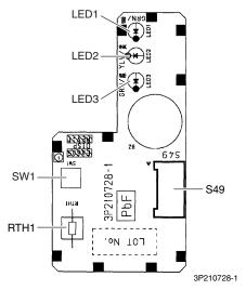
PCB (4): INTELLIGENT EYE Sensor PCB
