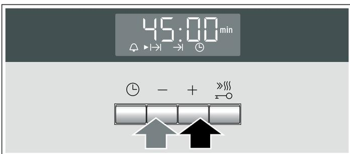
Le four se met en marche quelques secondes plus tard. Dans l'affichage, la durée s'écoule visiblement et le symbole ► l'>| est allumé. Les autres symboles de temps s'éteignent.
