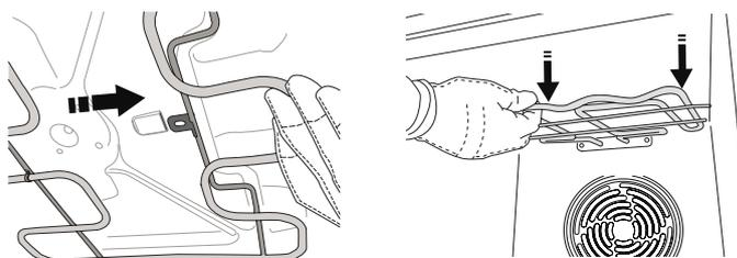
**2.** Pour replacer l'élément chauffant, soulevez-le, tirez légèrement vers l'avant, et assurez-vous que l'onglet de soutien est dans son appui.
