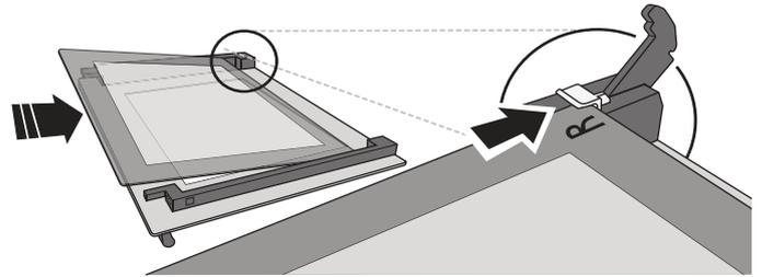
**4.** Remplacez le bord supérieur : un clique indique qu'elle est bien placée. Assurez-vous que le joint est bien placé avant de replacer la porte.
