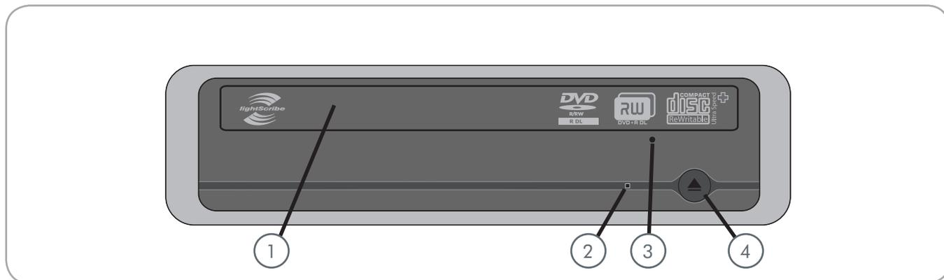
① **Tiroir du disque** Ouvrez le tiroir en appuyant sur le bouton de chargement/éjection des disques, et placez un CD ou un DVD sur le plateau, face imprimée vers le haut. Pour refermer le tiroir, appuyez sur le bouton de chargement/éjection de disque ou poussez légèrement le panneau avant du tiroir. Ce graveur n'est pas conçu pour recevoir de média avec cartouches.
