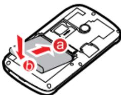
1. Orientez le côté marqué d'un **a** (comportant les contacts) vers l'extrémité inférieure de l'encoche de la batterie.
