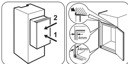
9. Fixez l'appareil au meuble d'encastrement à l'aide de 4 vis.
