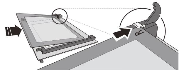
**4.** Remplacez le bord supérieur : un cliquet indique qu'elle est bien placée. Assurez-vous que le joint est bien placé avant de replacer la porte.
