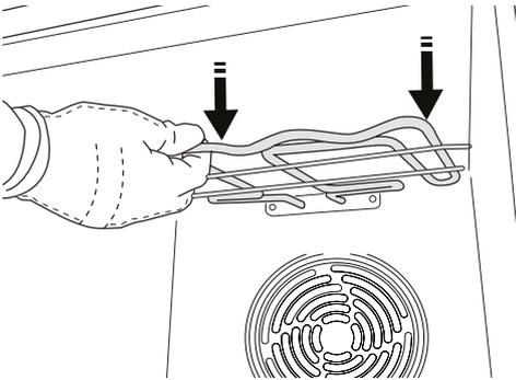
3. Pour replacer l'élément chauffant, soulevez-le, tirez légèrement vers l'avant, et assurez-vous que l'onglet de soutien est dans son appui.
