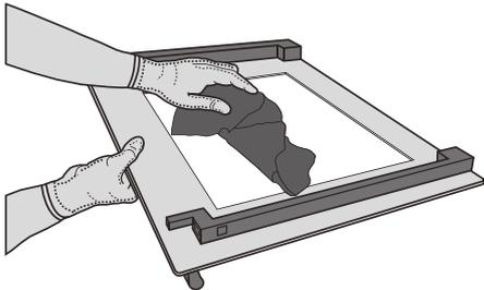
**3.** Pour bien replacer la vitre intérieure, assurez-vous que le « R » est visible dans le coin gauche et que la surface claire (pas d'imprimée) est placée vers le haut. En premier, insérez la longue partie de la vitre marquée d'un « R » dans les appuis des guides, abaissez-la ensuite en place.
