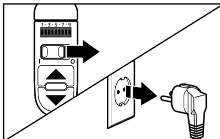
1 Si le batteur est en marche, glissez l'interrupteur en position « O » (arrêt) pour l'éteindre. Débranchez le batteur de la prise électrique.
