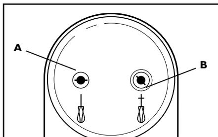
3 Insérez l'accessoire sans bague (C) dans la plus petite ouverture (A). Alignez puis appuyez pour verrouiller.
