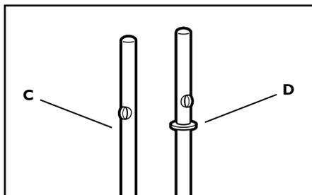
Les accessoires doubles (fouets Turbo, crochets pétrisseurs) comprennent un élément avec bague (D) et un autre sans bague (C). Les accessoires simples sont livrés avec une bague (D) (pied mélangeur) ou sans (C) (fouet).
