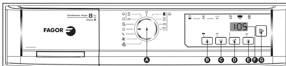
**A Sélecteur de programmes****B Sonnerie****C Anti-froissage****D Minuterie****E Départ différé****F Afficheur****G Départ/Pause**
