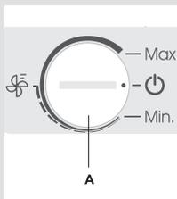
Pour mettre l'appareil en marche, tournez le bouton **A** dans le sens des aiguilles d'une montre vers la position **Max.** Lorsque le point figurant sur bouton est face à l'icône
