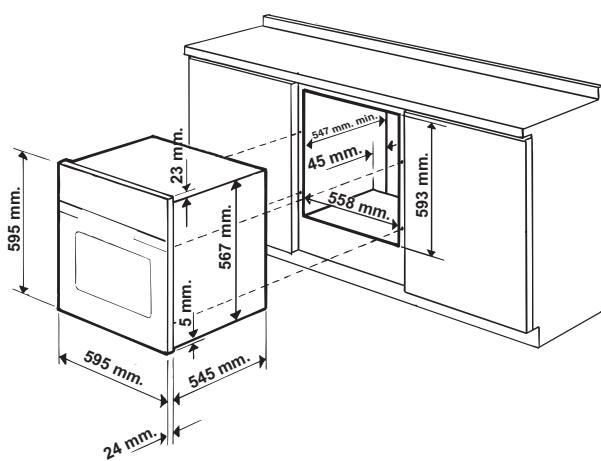
! Après encastrement de l'appareil, il ne doit plus y avoir possibilité de contact avec les parties électrifiées.
