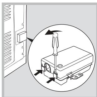
1. Pour ouvrir le bornier, faites pression à l'aide d'un tournevis sur les languettes latérales du couvercle : tirez et ouvrez le couvercle (*voir figure*).
