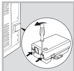
1. Abra el panel de bornes haciendo palanca con un destornillador sobre las lengüetas laterales de la tapa: tire y ábralo (*ver la figura*).
