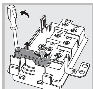
2. Desenrosque el tornillo de la mordaza de terminal de cable y extrágalo haciendo palanca con un destornillador (*ver la figura*).
