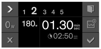
Remarque: Vous pouvez définir un temps d'égalisation entre deux puissances micro-ondes, afin que la température puisse se répartir uniformément à l'intérieur de l'aliment. Pour cela, effleurez le symbole  $O_w$  et réglez une durée à l'aide du sélecteur rotatif.
