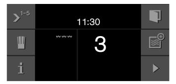
Selon le mode de fonctionnement sélectionné, le symbole pour micro-ondes ou le symbole pour gril grande surface apparaît dans le bandeau de commande de droite. Cela vous permet d'ajouter respectivement l'autre mode de fonctionnement.
