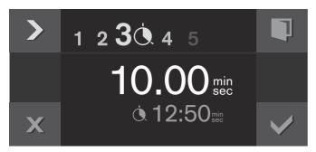
10 Confirmer avec ✓. Le menu principal du fonctionnement séquentiel apparaît. Les réglages des phases apparaissent dans la barre d'affichage.
