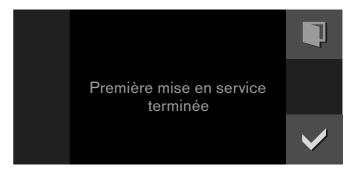
L'appareil se met en veille et l'afficheur apparaît en veille. L'appareil est maintenant prêt à fonctionner.
