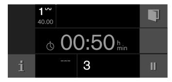
L'appareil se met en position d'attente. Le mode de fonctionnement, la puissance gril, le temps de cuisson et le temps restant jusqu'au démarrage sont indiqués dans l'affichage. L'appareil démarre au moment calculé et s'arrête automatiquement lorsque le temps de cuisson est écoulé.
