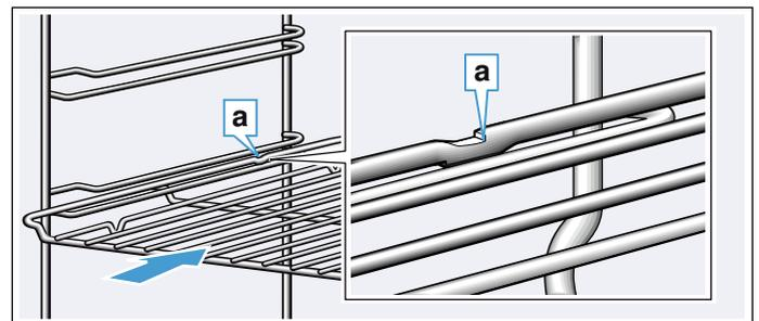
En introduisant des plaques, veillez à ce que l'encoche **a** soit à l'arrière et orientée vers le bas. La partie inclinée de l'accessoire **b** doit être orientée vers l'avant en direction de la porte de l'appareil.
