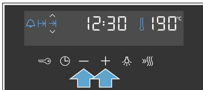
Au bout de quelques secondes, l'appareil valide les réglages. L'heure de la fin apparaît dans l'affichage. Dès que l'appareil démarre, la durée s'écoule.
