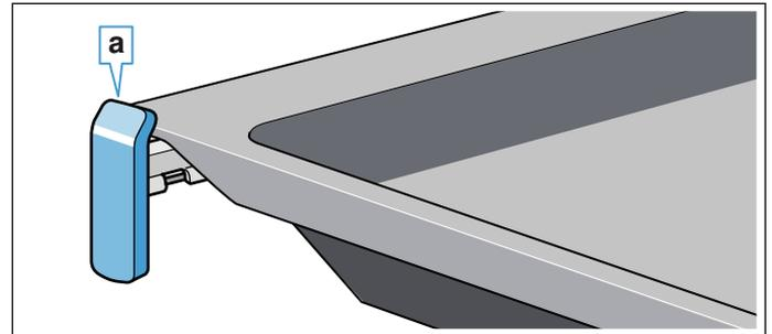
Les rails télescopiques s'encliquettent lorsqu'ils sont entièrement retirés. Il est ainsi facile de poser l'accessoire dessus. Pour le déverrouillage, repoussez les rails télescopiques dans le compartiment de cuisson avec une légère pression.
