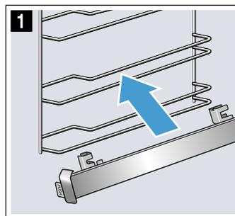
2. Introduisez la fixation à l'arrière entre la barre inférieure et la barre supérieure (fig. 2).
