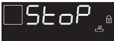
3. La porte reste bloquée jusqu'à quand la température à l'intérieur de la cavité de cuisson revient au niveau de sécurité. Attendez que le four ait refroidi (le voyant
