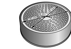
Afin d'obtenir de bons résultats de cuisson, le diamètre de la surface ferromagnétique doit, de préférence, être adapté à la taille de la zone de cuisson. Si le récipient n'est pas détecté sur une zone de cuisson, l'essayer sur la zone de diamètre immédiatement inférieure.
