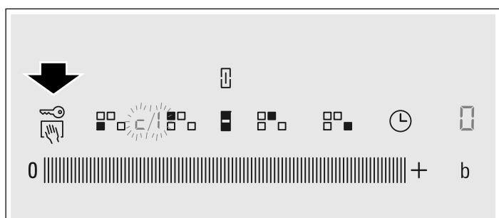
Sull'indicatore dei livelli di cottura lampeggiano *c* e *t* in maniera alternata e sull'indicatore del timer compare
