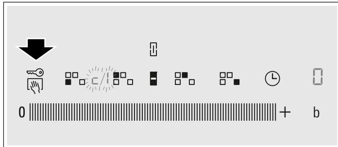
c et 1 clignotent en alternance dans l'affichage de la position de chauffe et 0 apparaît dans l'affichage de minuterie comme réglage par défaut.
