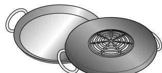
Pannen met aluminium kookzones in de bodem verkleinen de ferromagnetische zone, zodat het geleverde vermogen lager kan zijn en er problemen kunnen ontstaan bij de detectie van de pan en het kan zelfs zijn dat deze niet wordt gedetecteerd.
