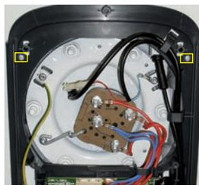
9. Vidanger la cuve et démonter l'ensemble chauffant (fourreau et élément chauffant).
