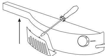
Om kylskåpet är utrustat med en sådan överliggande lampa som visas här nedan (figur A eller B), genomför följande steg för att byta ut glödlampan: avlägsna det transparenta skyddslocket genom att vidga hakarna med en skruvmejsel. Byt ut glödlampan, sätt tillbaka skyddslocket och koppla sedan på strömmen igen.
