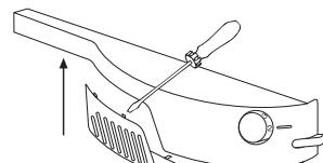
Wenn der Kühlschrank mit einem Oberlicht ausgestattet ist, wie es unten gezeigt ist (Abb. A oder B), nehmen Sie die unten beschriebenen Schritte vor, um die Glühbirne zu wechseln: Entfernen Sie mit einem Schraubendreher die durchsichtige Schutzabdeckung, indem Sie die Flügel ausweiten. Wechseln Sie die Glühbirne, bringen Sie die Schutzabdeckung wieder an, und schalten Sie das Gerät an.
