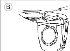
In Produkten mit TOTAL NO FROST Technologie befindet sich am Boden des Kühlfachs eventuell eine Säule mit LEDs. Diese ist nur in elektrischen und nicht in mechanischen Kühlschränken vorhanden. Wenden Sie sich an die Reparaturwerkstatt, wenn die LEDs gestört werden sollten oder nicht richtig funktionieren.
