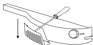
Draai het lampje los en vervang het door een soortgelijk lampje met hetzelfde vermogen.
