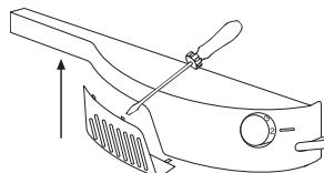
No caso de o frigorífico estar equipado com uma luz interior na parte superior, conforme abaixo indicado (figura A ou figura B), realize os passos acima indicados de modo a substituir a lâmpada: utilizando uma chave de fendas, remova a tampa transparente de protecção, alargando as asas. Substitua a lâmpada, reposicione a tampa de protecção e ligue o electrodoméstico.
