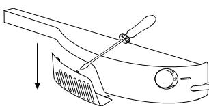
Vyšroubujte žárovku a vyměňte ji za žárovku stejného typu a stejněho výkonu.
