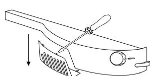
Ruuva vanha lamppu irti ja asenna uusi lamppu. Käytä alkuperäistä tyypipä olevaa lampua, jonka teho on sama.
