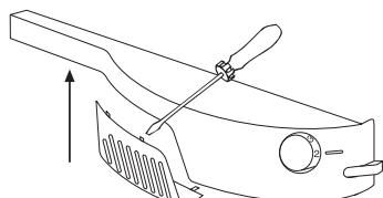
Jos jääkaapin yläosassa on valo alla olevan kuvan mukaisesti (kuva A tai kuva B), vaihda hehkulamppu yllä olevia ohjeita noudattaa: Poista läpinäkyvä suojuus ruuvimeisselillä käyttäen ja laajentamalla kielekkeitä. Vaihda hehkulamppu, asenna suojuus takaisin paikoilleen ja kytke laite päälle.
