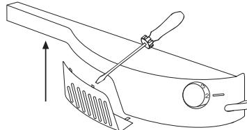
Hvis køleskabet er forsynet med ovenlys som vist nedenfor (figur A eller B), så følg de ovennævnte trin for at udskifte pæren. Fjern det beskyttende transparente dæksel ved at udvide vingerne ved hjælp af en skruetrækker. Udskift pæren, sæt beskyttelsesdækslet på igen og tænd for køleskabet.
