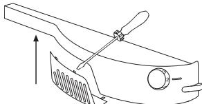
Σε περίπτωση που το ψυγείο διαθέτει φως στο πάνω μέρος όπως φαίνεται πιο κάτω (σχ. Α ή σχ. Β), εκτελέστε τα παρακάτω βήματα για να αντικαταστήσετε το λαμπτήρα: με ένα κατσαβίδιο, αφαιρέστε το διαφανές προστατευτικό κάλυμμα, ανοίγοντας τα πτερύγια. Αντικαταστήστε το λαμπτήρα, επανατοποθετήστε το προστατευτικό κάλυμμα και ενεργοποιήστε τη συσκευή.
