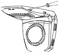
I produkter med TOTAL INGEN AFRIMNINGS teknologi kan der være en blok med lysdioder nederst i køleskabet, findes kun i elektrisk type produkter og ikke i mekaniske produkter. Kontakt forhandleren, hvis lysdioderne skulle bliver defekte eller ikke virker korrekt.
