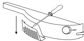
Schrauben Sie das Lämpchen heraus und ersetzen Sie es durch ein baugleiches Lämpchen mit der gleichen Leistung.
