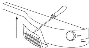
Si el frigorífico está equipado con una luz de sobrecarga tal y como se muestra a continuación (figura A o figura B), adopte las siguientes medidas para sustituir la bombilla de la luz: utilizando un destornillador, retire la cubierta transparente de protección, ampliando las pestañas. Sustituya la bombilla de la luz, vuelva a colocar la cubierta de protección y conecte el aparato.
