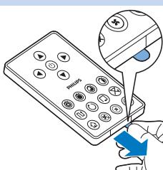
O telecomando funciona com uma pilha CR2025 tipo botão. Esta pilha é protegida com uma patilha de protecção que tem de ser retirada antes da utilização.
