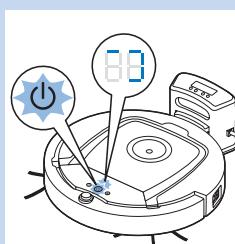
**4** Quando la batteria è completamente carica, l'indicatore di stato della batteria sul display della docking station e la spia del pulsante on/off sul robot smettono di lampeggiare.
