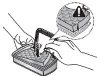
6. Remettez le groupe filtrant réassemblé dans le corps de l'aspirateur.
