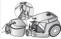
6. Avant réutilisation, poussez le réservoir de poussière à l'intérieur du corps de l'aspirateur jusqu'à entendre un « clic ».
