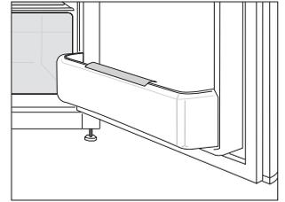
Tous les balconnets et les bacs peuvent être enlevés pour le nettoyage. Pour les extraire de la porte, tapoter avec le poing du bas vers le haut d'abord d'un côté puis de l'autre dans la zone d'introduction. Éviter d'enfiler dans le porte-bouteilles des bouteilles trop lourdes et de les laisser tomber sur le fond au moment de leur mise en place.
