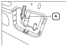
3. Raccordez le tuyau fourni (tuyau de vidange long) **B** à l'orifice situé à côté de la pièce à laquelle est raccordé le tuyau de vidange **A**.
