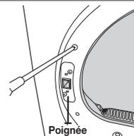
12. Placez-vous du côté droit de l'appareil et serrez les deux vis maintenant le châssis avant et les deux vis maintenant la poignée.
