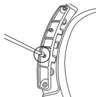
10. Retirez les deux vis maintenant le châssis avant sur la gauche.
