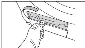
2. Déverrouillez la fixation du condensateur.
