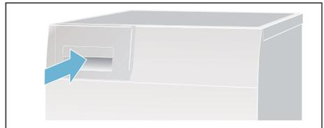
**Remarque :** Le filtre du réservoir d'eau de condensation filtre l'eau de condensation utilisée pour le nettoyage automatique de votre sèche-linge. Le filtre est nettoyé en vidant l'eau de condensation. Vérifiez régulièrement que le filtre ne contient pas de dépôt et retirez-les le cas échéant. Voir → Page 25.
