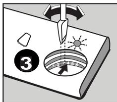
On peut régler le doseur de produit de rinçage de 1 à 6. Le doseur est réglé à la position 3 en usine.
