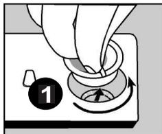
dévissez le bouchon du compartiment jusqu'à ce
