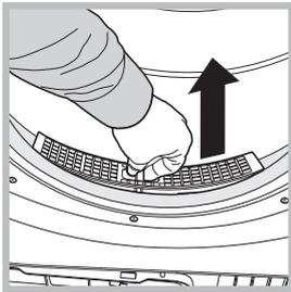
Par conséquent, une fois le séchage terminé, nettoyez le filtre en le rinçant sous l'eau courante ou avec votre aspirateur. Si le filtre devient bloqué, le flux d'air à l'intérieur du sèche-linge est sérieusement compromis : les temps de séchage sont allongés et vous consommez davantage d'énergie. Cela peut aussi endommager votre sèche-linge. Le filtre se trouve devant le joint du sèche-linge
