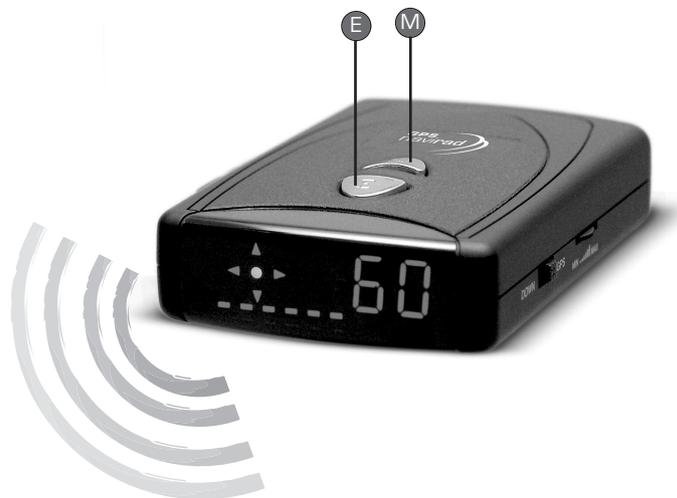
Pour contrôler le fonctionnement de votre GPS Navirad, vous pouvez lancer le mode d'auto démonstration en pressant les deux boutons simultanément pendant 2 à 3 secondes. Ce mode vous permet de tester l'ensemble des messages, des sons, des affichages et des données de la base d'information géographique.
