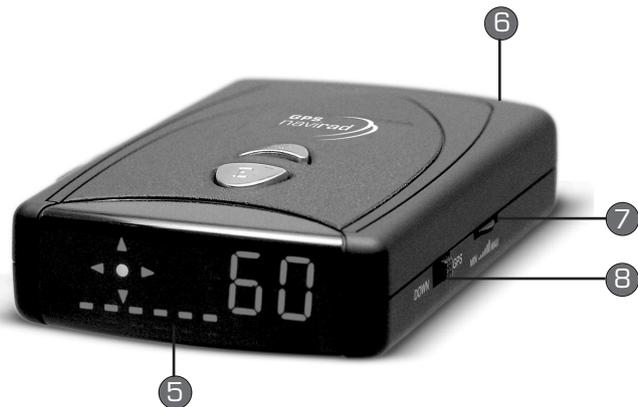
5. **Afficheur digitale** : Indique la vitesse et la direction de déplacement du véhicule. A proximité d'une zone à risque il affiche également la distance.
