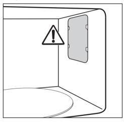
N'enlevez pas la protection située devant l'orifice de sortie des microondes dans l'enceinte de cuisson, ni la feuille qui se trouve sur la face intérieure de la porte.  Vérifiez qué appareil ne présente aucun dommage.
