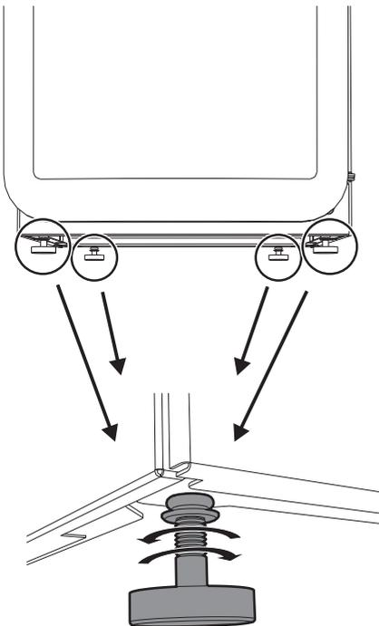
Pour faciliter une fermeture correcte de la porte, inclinez légèrement l'appareil vers l'arrière.
