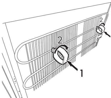
Pour mettre les entretoises en place, introduisez-les entre les barres verticales du condensateur (1), tournez-les ensuite de 90 degrés, dans le sens horaire ou anti-horaire, de façon à les fixer (2).
