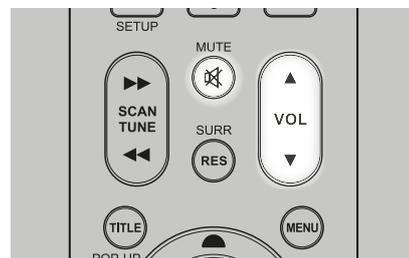
En plus du bouton de Volume utilisez les touches VOL [▲/▼] de la télécommande AVR 4 pour régler le « volume principal » du T 758, c'est à dire pour augmenter ou baisser toutes les voies en même temps. Une impulsion momentanée sur la touche correspondante permet d'augmenter ou de diminuer le volume principal par pas de 1 dB. Si vous maintenez enfoncée la touche VOL [▲/▼], l'augmentation ou la diminution du volume se fait de façon « continue » jusqu'à ce que vous relâchiez la touche.
