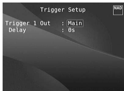
Le T 758 comporte Sortie Asservissement +12 V CC [+12V DC Trigger Output] que vous pouvez utiliser pour activer un appareil ou une chaîne qu'il alimente. Le asservissement est des signaux basse tension utilisés pour allumer/éteindre d'autres appareils conformes.
