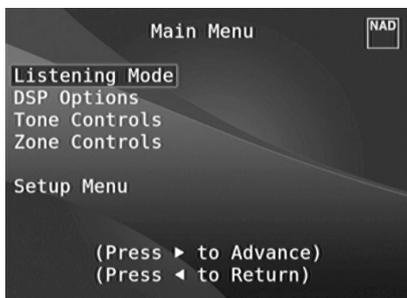
Le Menu Principal contient les options de menu pour le « Listening Mode » (Mode d'Écoute), les « DSP Options » (Options DSP), les « Tone Controls » (Commandes de Tonalité), les « Zone Controls » (Commandes de Zones) et l'accès au « Setup Menu » (Menu de Configuration).
