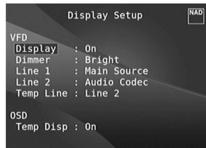
L'affichage Vide-Fluorescent (VFD) et les Incrustations à l'Écran (OSD) peuvent afficher les informations de différentes façons, grâce aux paramètres qui se trouvent dans le menu « Display Setup » (Configuration de l'Affichage). Combinez les touches [◀/▶] ou ENTRÉE [ENTER] et [▲/▼] pour naviguer dans les rubriques du menu de Configuration de l'Affichage.
