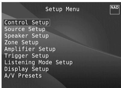
Le Menu de Configuration vous permet de personnaliser le fonctionnement du T 758 en fonction des appareils auxiliaires dont vous disposez sur votre chaîne A/V. Si votre chaîne ne correspond pas exactement à la configuration par défaut indiquée dans le Guide de Mise en Marche Rapide fourni, il vous sera nécessaire d'utiliser le menu de configuration pour configurer les entrées du T 758.
