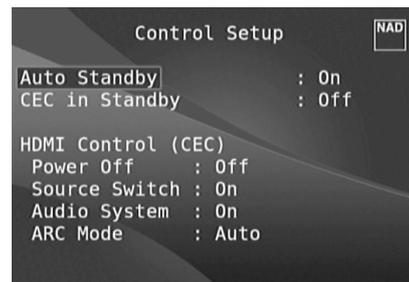
Le T 758 prend en charge les fonctions de commandes HDMI (CEC) et de retour de canal audio (ARC). Les deux fonctions sont possibles si des appareils externes prenant en charge ces fonctions sont branchés au T 758 par la connexion HDMI.
