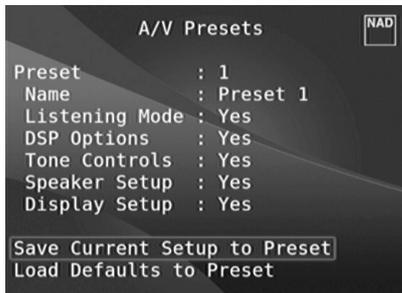
Avec la ligne de menu « Save Current Setup to Preset » (Enregistrer la configuration actuelle à un préréglage) sélectionnée, appuyez sur [D] pour sauvegarder les paramètres ci-dessus dans le « Preset 1 » (Préréglage 1). L'OSD ci-dessous s'affiche pour confirmer que les paramètres ci-dessus ont été sauvegardés dans le « Preset 1 » (Préréglage 1).
