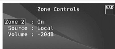
En fonction des paramétrages effectués au moyen du menu spécifique de « Configuration des Zones » décrit à la rubrique concernant le « Menu de Configuration, » il est possible de configurer et de gérer la Zone concernée grâce à cette fenêtre de « Commandes de la zone ».
