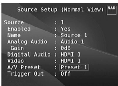
Dans l'exemple ci-dessus, les paramètres de « Preset 1 » (Préréglage 1) sont sélectionnés pour la source 1. Lorsque la source 1 est accédée, les paramètres de « Preset 1 » (Préréglage 1) sont appliqués à la source 1. Vous pouvez tout de même sélectionner manuellement un autre préréglage pour une source spécifiée en appuyant sur les touches de la télécommande appropriées.
