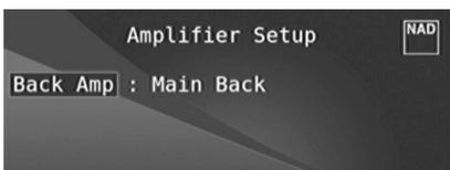
Si les haut-parleurs ambiophoniques arrière ne sont pas utilisés dans la zone principale, les voies de l'amplificateur ambiophonique arrière pourront être affectées à une utilisation « Main Back » (Arrière Principale), « Main Front » (Avant Principale) (Bi-Ampli) et Zone 2.
