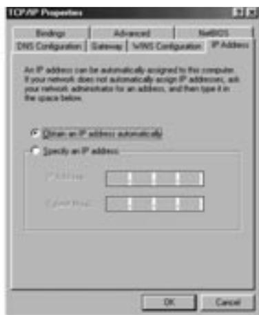
6. Sélectionnez l'option « Obtain an IP address automatically » (Obtenir automatiquement une adresse IP).
