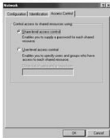
12. Cliquez sur l'onglet « Access Control » (Contrôle de l'accès) et définissez le contrôle de l'accès au niveau partage. Cliquez sur « OK ».
